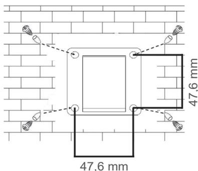
Forare la parete in corrispondenza dei 4 fori del supporto per il montaggio a muro.
