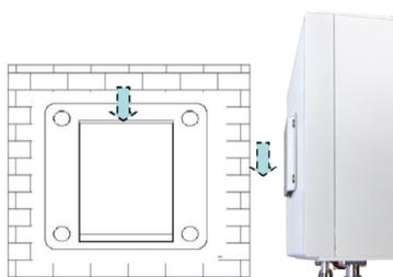
Installare il supporto con la linguetta per l'incastro rivolta verso l'alto. Infilare la parte posteriore dell'amplificatore nell'incastro del supporto, precedentemente fissato al muro.
