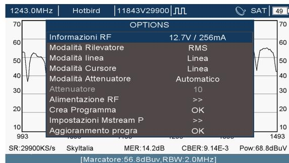
Fig. 13 Opzioni in modalità spettro in banda SAT
