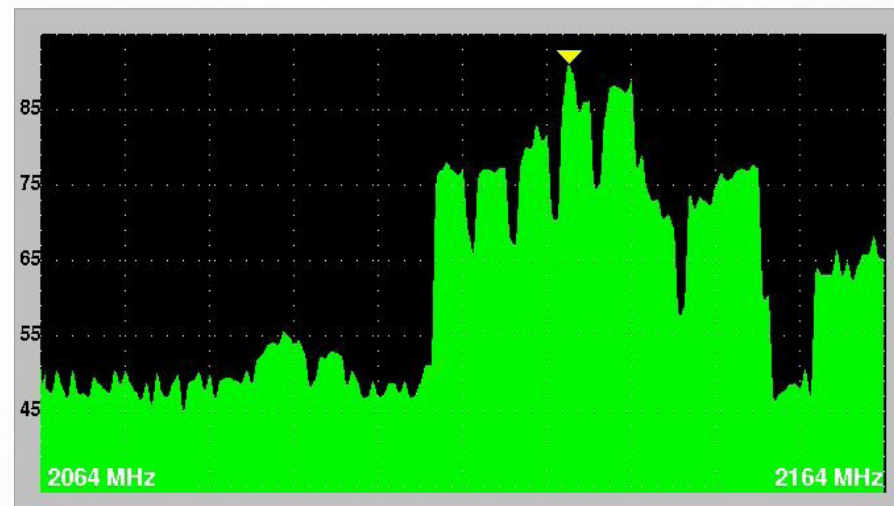
Esempio di misurazione del segnale in banda 2100 MHz
