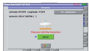
Bussola elettronica per velocizzare le operazioni di allineamento della parabola.
