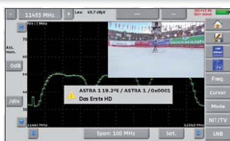
Analisi dello spettro in frequenza che consente di individuare canali adiacenti e spurie.
