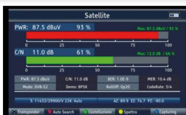
Misure SAT. Tutte le misure vengono visualizzate in un'unica schermata.
