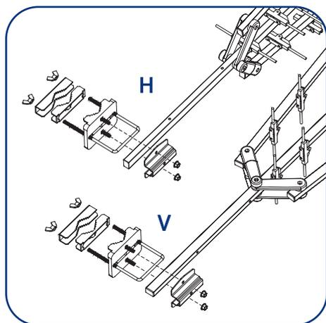
1) Montare il giunto di attacco al palo in orizzontale (H) o in verticale (V) a seconda della polarizzazione richiesta.
