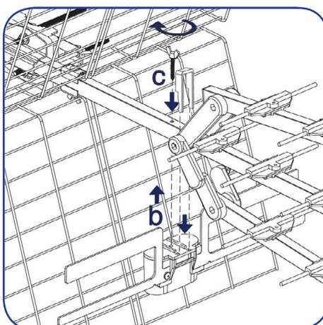
5) Orientando il dipolo (d) come da immagine, fissarlo sulla culla con l'apposita vite a galletto (e) in corrispondenza del foro passante. Inserire il fermo in plastica ABS nell'apposita sede rispettando il verso come in figura.
