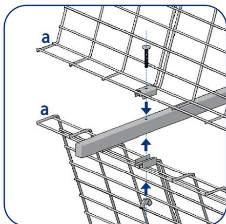
4) Fissare i 2 riflettori (a) alla culla dell'antenna in modo che risultino inclinati in avanti verso gli elementi utilizzando la vite con dado ad alette.
