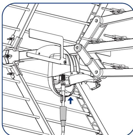
5) Inserire il cappuccio di gomma waterproof sul cavo coassiale prima di montare il connettore. Passare il cavo attraverso le maglie del riflettore, aprire lo sportellino frontale del dipolo e collegare il connettore F.
