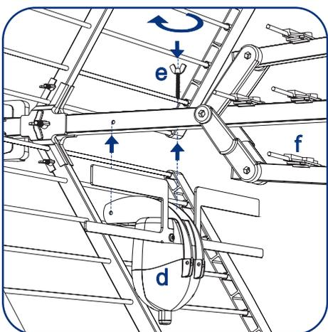
4) Fissare il dipolo (d) sulla culla centrale dell'antenna in modo che il coperchio apribile guardi gli elementi (f), fissandolo con l'apposito galletto (e) in corrispondenza del foro passante.
