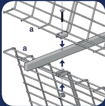
1) Fissare i due riflettori (a) alla culla dell'antenna in modo che risultino inclinati in avanti verso gli elementi utilizzando la vite con dado ad alette.
