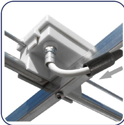
5) Inserire il cappuccio di gomma waterproof sul cavo coassiale prima di intestare il connettore. Collegare il connettore F.
