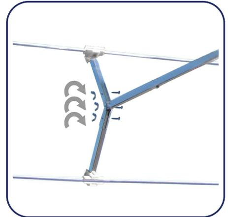
3) Il riflettore, qualora sia previsto, si compone di due elementi e deve essere fissato all'estremità della culla in corrispondenza del foro passante mediante i due giunti metallici e le tre viti a galletto.
