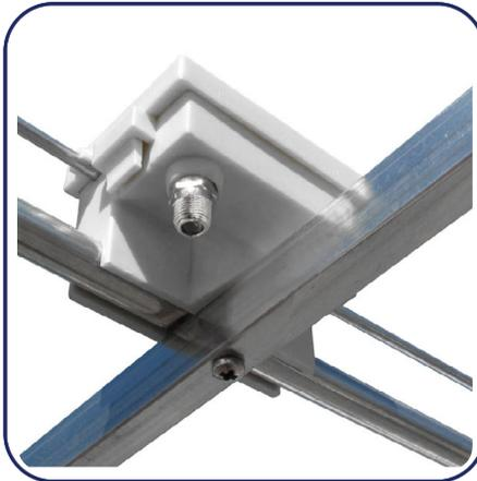
2) Montare il dipolo sulla culla fissandolo con l'apposita vite (contenuta nel sacchetto accessori) in corrispondenza del foro passante e posizionandolo, con il coperchio verso l'alto, sullo stesso piano in cui si trovano gli elementi, verificando che il connettore F sia orientato verso l'elemento avente alle estremità tappi di colore rosso.
