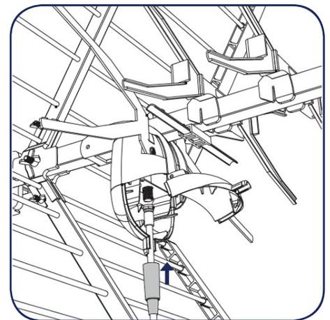
6) Inserire il cappuccio di gomma waterproof sul cavo coassiale prima di montare il connettore. Passare il cavo attraverso le maglie del riflettore, aprire lo sportellino frontale del dipolo e collegare il connettore F. Chiudere lo sportellino e inserire il cappuccio di gomma waterproof sull'apposito attacco passacavo del dipolo. Nei modelli a 70 e 75 elementi invece di passare il cavo coassiale attraverso le maglie del riflettore, fissarlo alla culla di supporto.
