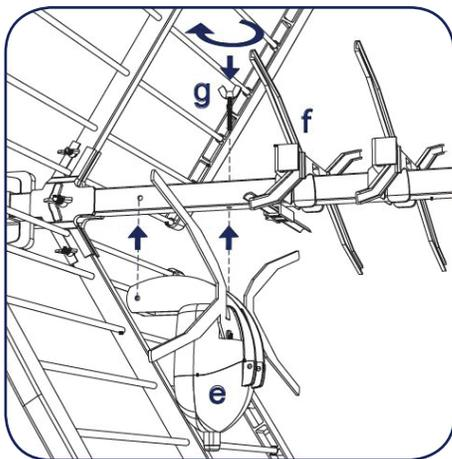
4) Fissare il dipolo (e) sulla culla centrale dell'antenna in modo che il coperchio apribile guardi gli elementi (f), fissandolo con l'apposito galletto (g) in corrispondenza del foro passante.
