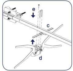
2) Ruotare l'elemento premontato (c) sotto la culla in modo che la linguetta d'arresto del giunto di plastica sia rivolta in avanti. Orientare il dipolo (d) come da immagine, fissarlo sulla culla con l'apposita vite autofilettante (e) in corrispondenza del foro passante e dalla parte opposta agli ancoraggi previsti per il montaggio degli elementi. Inserire il fermo in plastica ABS nell'apposita sede rispettando il verso come in figura.
