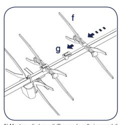
3) Montare gli elementi (f) sopra la culla inserendoli negli ancoraggi (g) previsti per il montaggio degli elementi.
