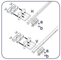
1) L'attacco al palo è premontato sulla culla per ricevere la polarizzazione orizzontale. Se si desidera ricevere la polarizzazione verticale occorre svitare le due viti (a) e (b), sfilare la culla dell'antenna e ruotarla di 90° sull'attacco al palo, posizionare nella sede e stringere le viti.
