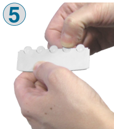
5 Sfilare il frontalino e rimuovere i fori pretagliati in corrispondenza dei connettori a cui verranno collegati i cavi.
