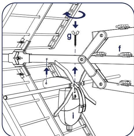
7) Fissare il dipolo (i) sulla culla centrale dell'antenna in modo che il coperchio apribile guardi gli elementi (f), fissandolo con l'apposito galletto (g) in corrispondenza del foro passante.
