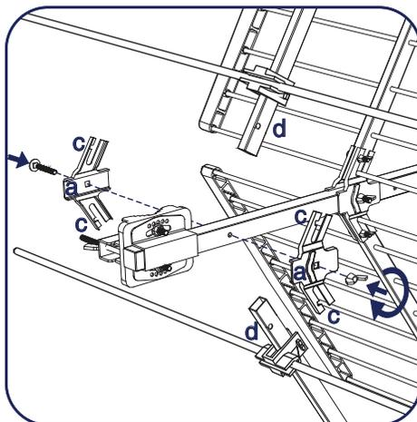
5) Fissare i 2 giunti (a) alla culla dell'antenna utilizzando l'apposita vite con dado ad alette. Inserire i 2 bracci nelle loro sedi, avendo cura di fare corrispondere il foro (b) con l'asola dei giunti (d).
