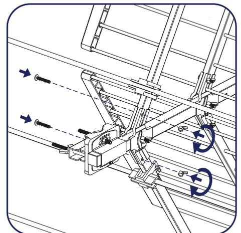
6) Bloccare i 2 bracci con gli elementi tubolari fissandoli al giunto con con le apposite viti con dado ad alette.
