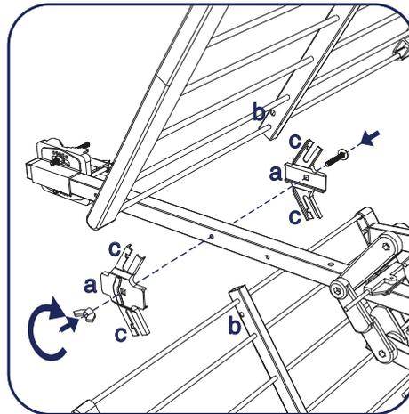
2) Fissare i 2 giunti (a) alla culla dell'antenna utilizzando l'apposita vite con dado ad alette. Inserire i 2 riflettori nelle loro sedi, avendo cura di fare corrispondere il foro (b) con l'asola dei giunti (c).
