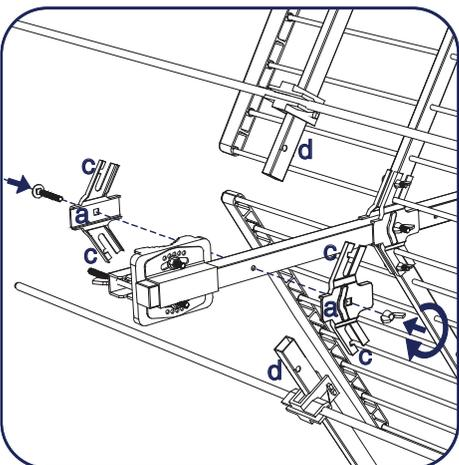
4) Fissare i 2 giunti (a) alla culla dell'antenna utilizzando l'apposita vite con dado ad alette. Inserire i 2 bracci nelle loro sedi, avendo cura di fare corrispondere il foro (b) con l'asola dei giunti (d).
