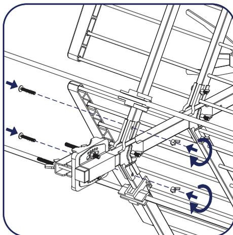
5) Bloccare i 2 bracci con gli elementi tubolari fissandoli al giunto con con le apposite viti con dado ad alette.
