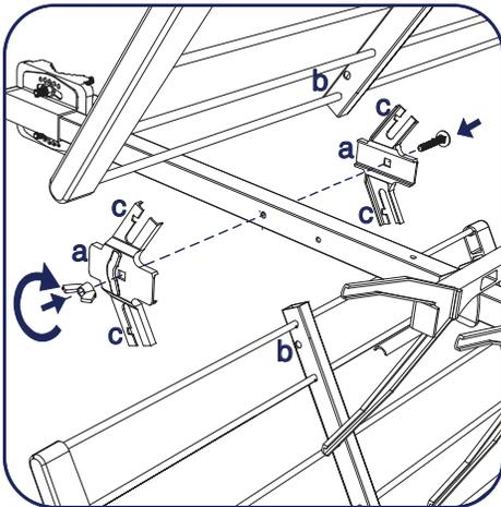
1) Fissare i 2 giunti (a) alla culla dell'antenna utilizzando l'apposita vite con dado ad alette. Inserire i 2 riflettori nelle loro sedi, avendo cura di fare corrispondere il foro (b) con l'asola dei giunti (c).
