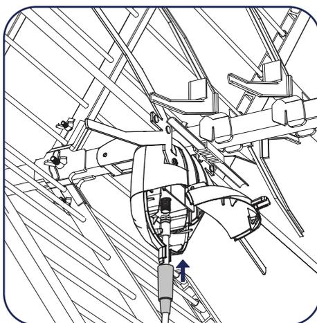
8) Inserire il cappuccio di gomma waterproof sul cavo coassiale prima di montare il connettore. Passare il cavo attraverso le maglie del riflettore, aprire lo sportellino frontale del dipolo e collegare il connettore F.
