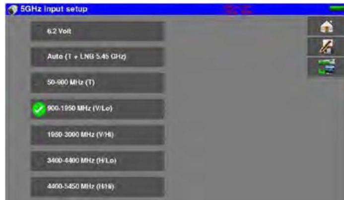
Da questo menu è possibile attivare la telealimentazione 6,2 V del vostro LNB a 5,45 GHz e scegliere la banda su cui lavorare:
