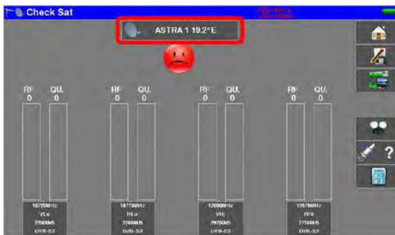
Se il vostro satellite non è nella lista è possibile inserire un nuovo satellite. Orientate lentamente la parabola satellitare fino a quando sentite la melodia di aggancio per ottenere la migliore qualità.
