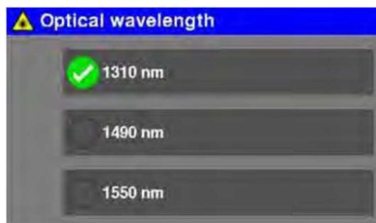
Nella ricezione satellitare si usa principalmente la lunghezza d'onda da 1310nm (controllare questa informazione sull'LNB da installare). Ora è possibile puntare la parabola (vedere il Capitolo 2 per l'installazione di una parabola).
