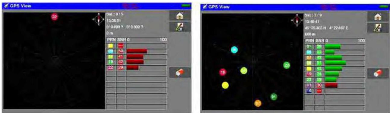
I satelliti che vengono rilevati appaiono secondo un certo schema; i satelliti non bloccati lampeggiano.
