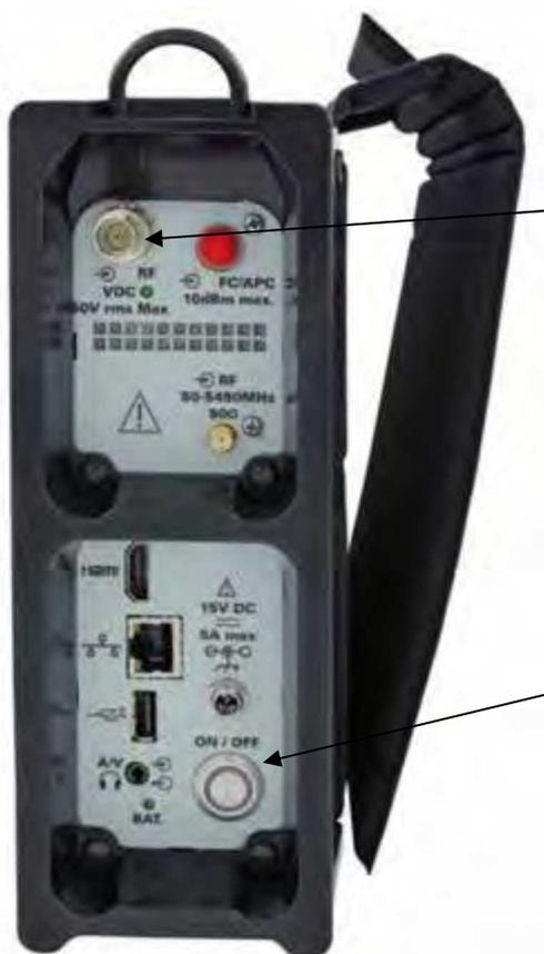
Connettore RF da usare con un adattatore F/F fornito con lo strumento.
