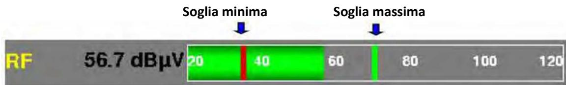
Queste soglie sono utilizzate per visualizzare le misure del Livello di Potenza e Mappa delle Misure.
