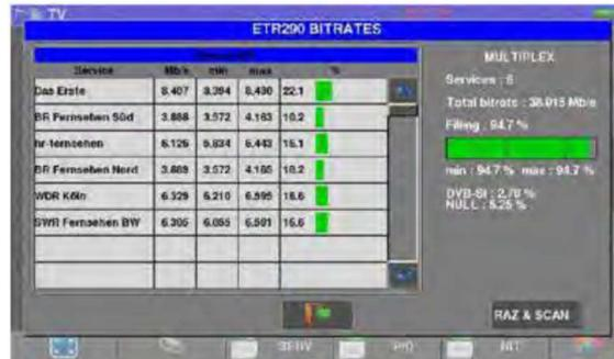
Lo strumento analizza il flusso di trasporto (TS) e misura per ogni servizio la velocità trasmissiva in Mb/s e l'occupazione di banda nel multiplex. Nella lista dei servizi - per ogni servizio - sono visualizzati:
