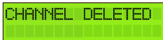
Per eliminare un canale, posizionare la freccia sul canale e premere il pulsante rotante per 3 secondi.
