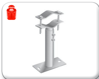
Zanca tubolare telescopica Palo Ø 40÷70 mm (07-623/A) Palo Ø 40÷90 mm (altri art.) Piastra 200x70x4 mm Art. 07-623/A L 7÷12 cm Art. 07-623 L 15÷22 cm Art. 07-624 L 25÷42 cm
