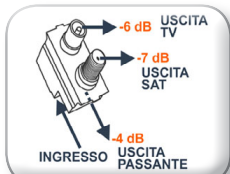
Schema di funzionamento di una presa OPS6 DEM TV/SAT cc (art. 27-534)
