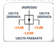
Schema di funzionamento di un P2-12 DIGIT (art. 27-181)
